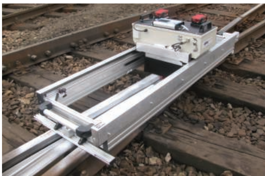
8. Skorpion - urządzenie do pomiarów 3D
