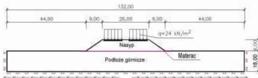
3. Schemat obliczeniowy dla nasypu zbrojonego w poziomie podstawy (ruch lekkich pojazdów)
