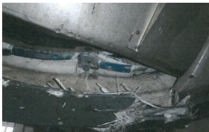
5. Uszkodzony dolny zgarniacz oraz osłona klap dziobowych [Kałuża i in. 2015]
