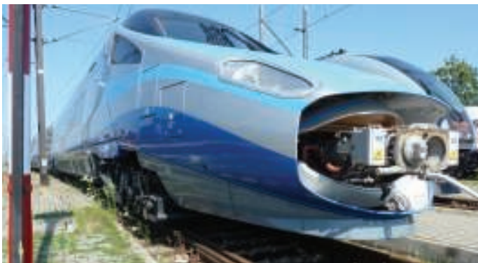
2. Przód pociągu Pendolino z elementami wrażliwymi na udary mechaniczne [fot. Marek Stolarski]
