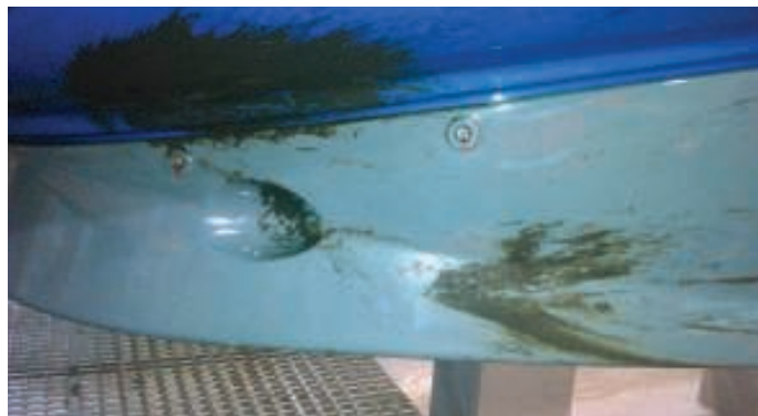
3. Szczątki biologiczne na obudowie aerodynamicznej (koszt dezynfekcji około 2000 EURO) [Kałuża i in. 2015]
