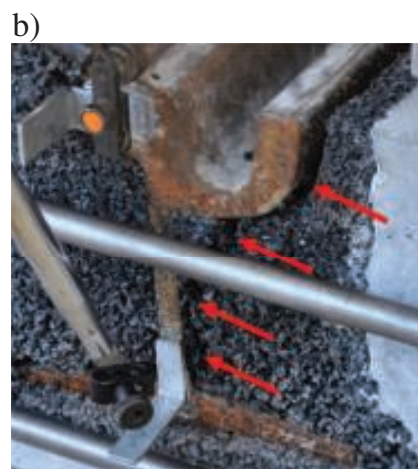
7. Widok uszkodzeń próbki serii „B”: a) odspojenie główki szyny od elastomeru po 5 tys. cykli, b) odspojenie od główki i szynki po 3 mln cykli
