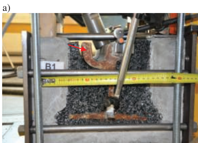
7. Widok uszkodzeń próbki serii „B”: a) odspojenie główki szyny od elastomeru po 5 tys. cykli, b) odspojenie od główki i szynki po 3 mln cykli
