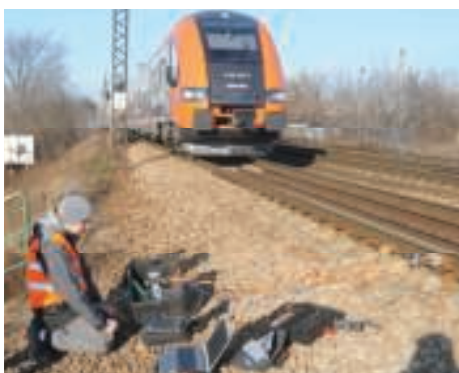
4. Pomiaru testujące czujniki przyspieszeń oraz czujniki ugięć dynamicznych nawierzchni
