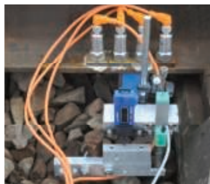
4. Pomiaru testujące czujniki przyspieszeń oraz czujniki ugięć dynamicznych nawierzchni
