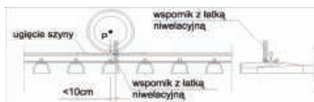
9. Schemat rozmieszczenia latek niwelacyjnych na stopce szyny
