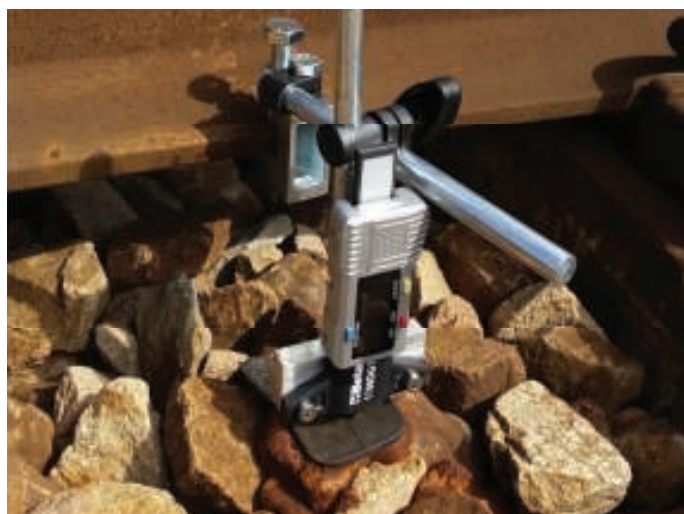
8. Linial elektroniczny do pomiaru ugięć dynamicznych szyny
