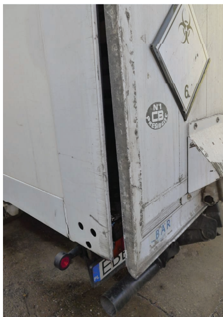
4. Kilkucentymetrowa szczelina pomiędzy burtą załadowniczą a ścianami furgonu i brak tylnych drzwi nie zapewnia pyłoszczelności
