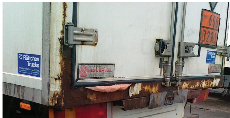
6. Uszkodzone uszczelki i niestarannie zamknięte drzwi
