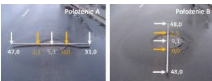
7. Przykładowe wyniki pomiaru deformacji studni zlokalizowanej na odcinku ulicy Podwałe Przedmiejskie w Gdańsku
