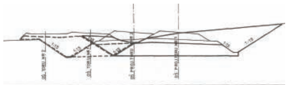
3. Przekrój podłużny przebudowanego podtorza [6]
