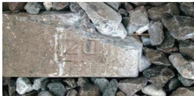
5. Uszkodzenie podkładu wskutek działania alkaliów [15]
