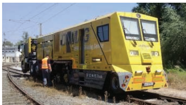
2. Frezarka dwudrogowa typu SF-02 W-FS Truck
