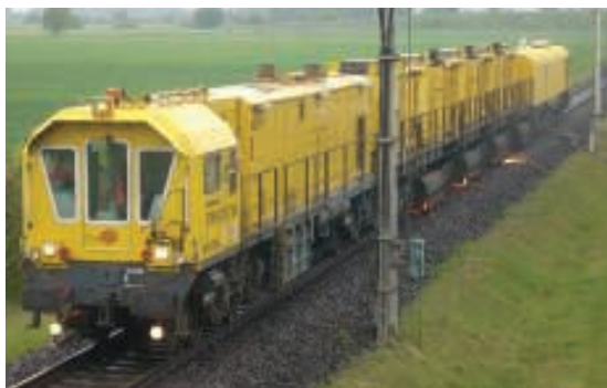
1. Szlifowanie zmechanizowane na torze doświadczalnym Instytutu Kolejnictwa
