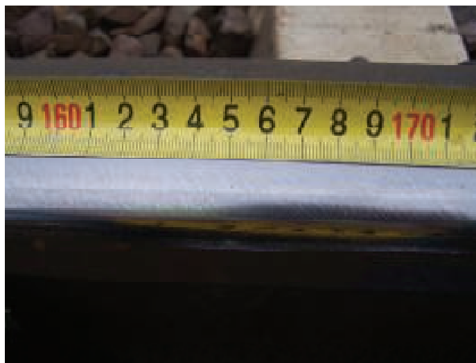
2. Początkowa faza rozwoju wad 2223 head checks (wiosna 2011; linia kolejowa nr 131)
