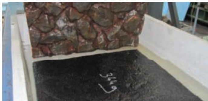
4. Badanie mrozoodporności - widoczna profilowana płyta obciążeniowa imitująca podsypkę [4]
