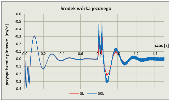
5. Przebiegi czasowe pionowego przyspieszenia środka wózka jezdnego, wyznaczone w dwóch wybranych przypadkach nierówności progowej toru
