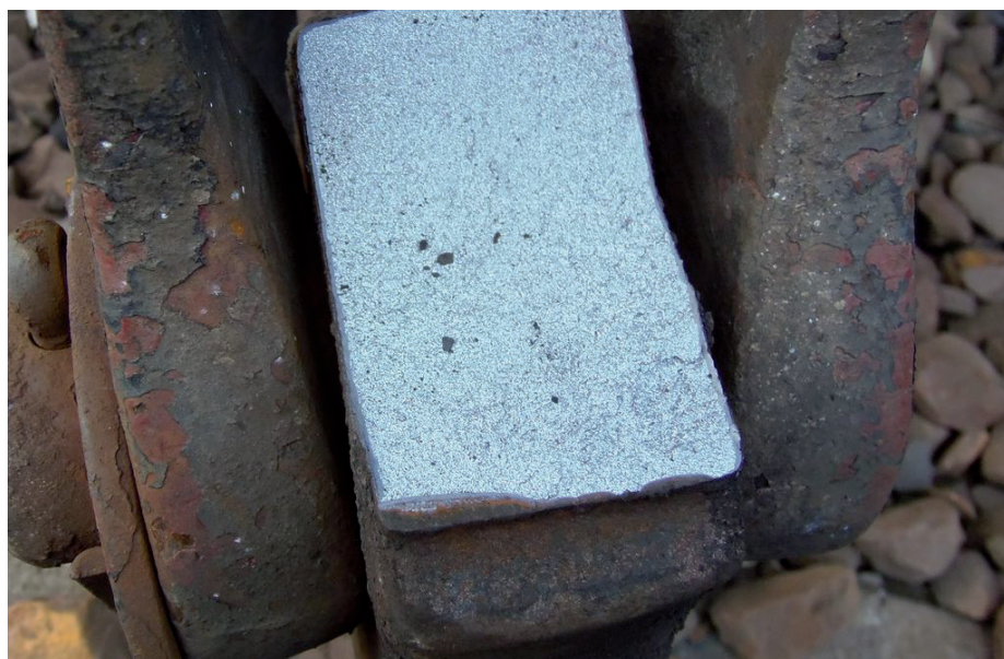
4. Przełom drąga haka - widok na zerwany łeb haka
