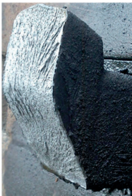
3. Przełom drąga haka - widok na ostoję wagonu
