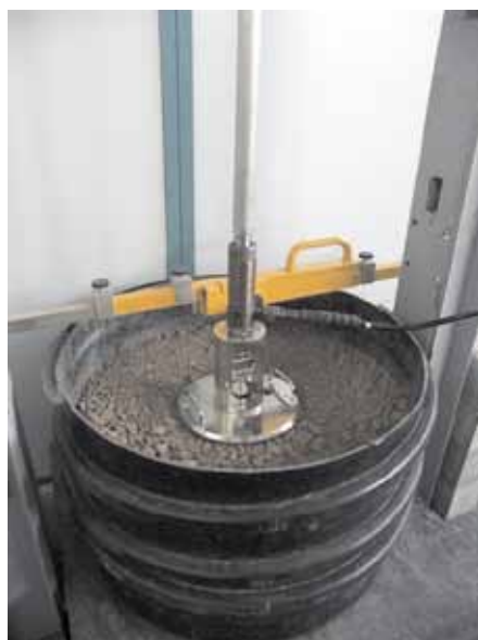
4. Płyta statyczna VSS do badania modułu odkształcenia
