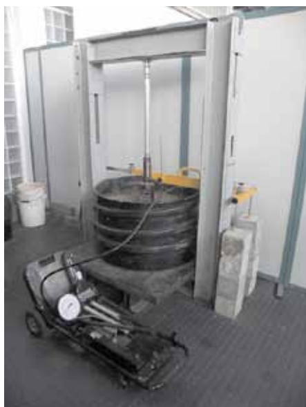
3. Aparatura VSS do oznaczania modułu odkształcenia
