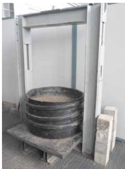
1. Stanowisko do badań sztywności torowiska
