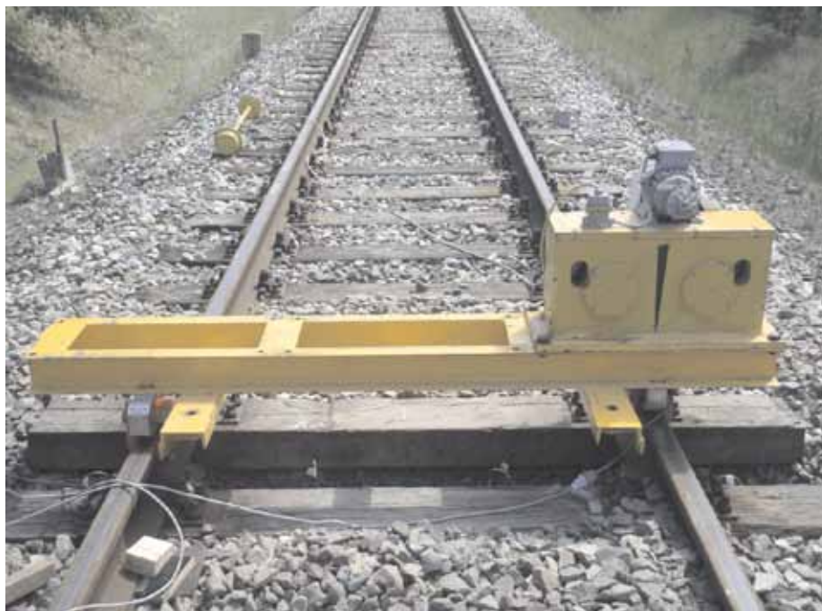
1. Wzbudnik bezwładnościowy rotacyjny wraz z siłownikami pałkowymi
