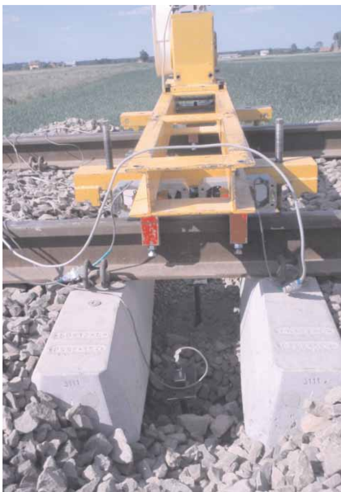
6. Stanowisko badawcze na odcinku toru kolejowego zbudowanego z podkładów strunobetonowych z wibroizolacją
