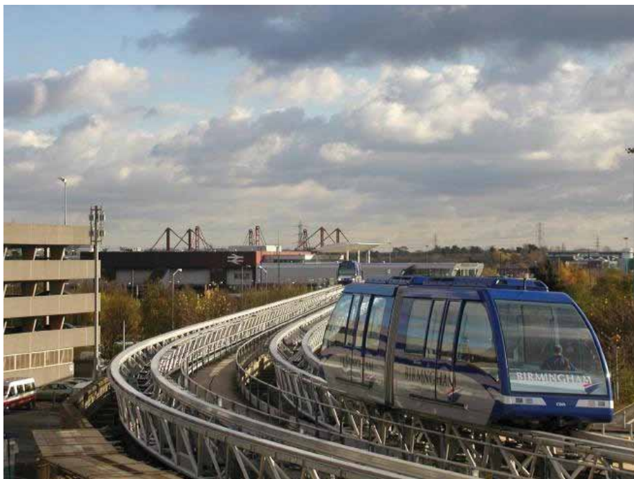
4. Przykład zastosowania tramwaju linowego na lotnisku w Birmingham w Wielkiej Brytanii, źródło: [5]
