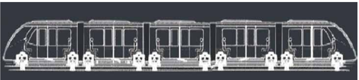
3. Tramwaj linowy (pojazd modułowy) o pojemności 160 osób, źródło: [3]
