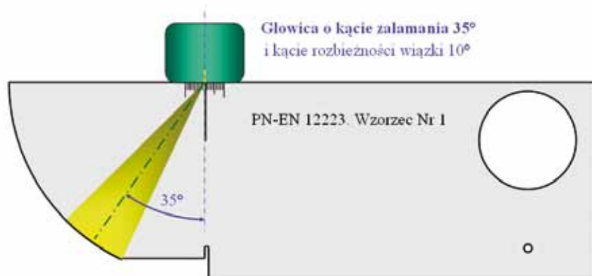
8. Głowica kątowa 35° na wzorcu nr 1 (PN-EN 12223)
