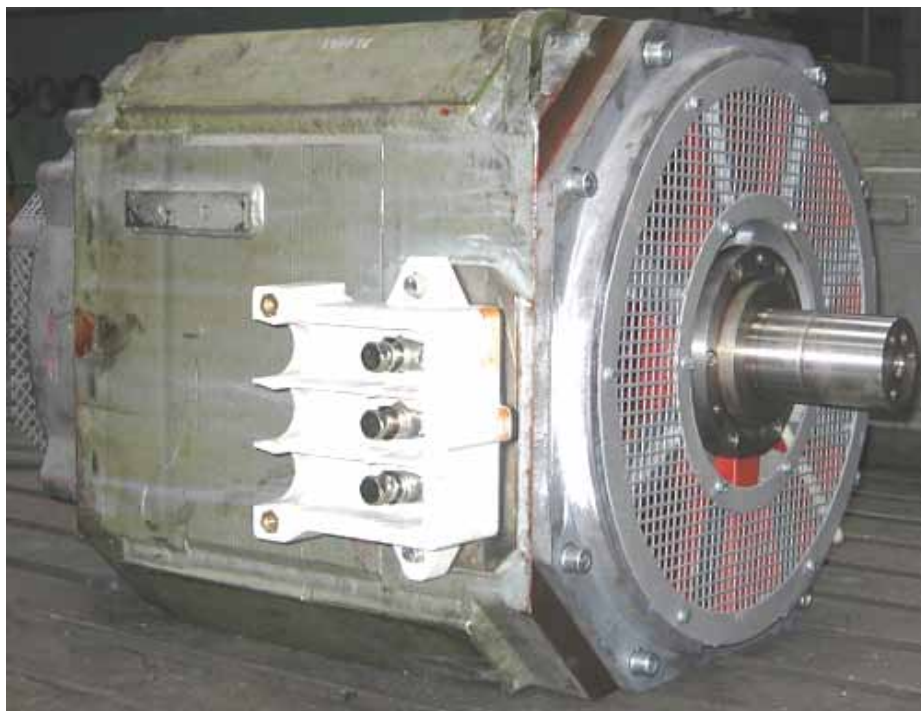
4. Silnik STDa280-4B, 180 kW, do napędu metra Warszawskiego
