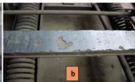
11 a, b, c. Uszkodzenia ślizgacza miedzianego spowodowane wydzielaniem się ciepła w czasie powstania łuku elektrycznego
