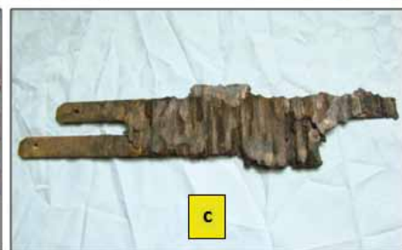
11 a, b, c. Uszkodzenia ślizgacza miedzianego spowodowane wydzielaniem się ciepła w czasie powstania łuku elektrycznego
