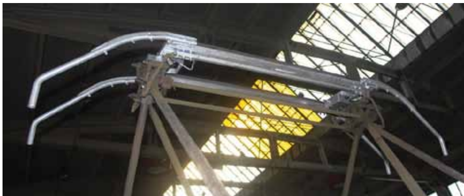
17. Pomiarowy ślizgacz zamontowany na pantografie
