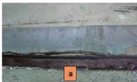
11 a, b, c. Uszkodzenia ślizgacza miedzianego spowodowane wydzielaniem się ciepła w czasie powstania łuku elektrycznego
