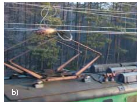
10 a, b. Iskrenie pantografów spowodowane oblodzeniem sieci trakcyjnej
