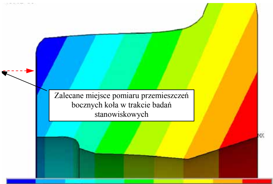
5. Rozkład przemieszczeń sumarycznych w kierunku osiowym (oś y) dla przykładowego koła kolejowego o średnicy nominalnej \varnothing 920 \text{ mm} w czasie 5400 s
