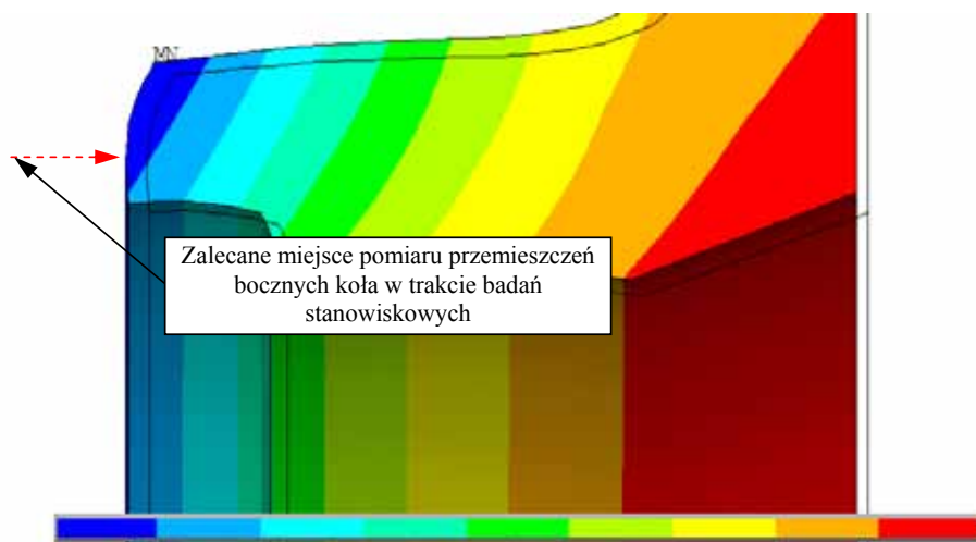
6. Rozkład przemieszczeń sumarycznych w kierunku osiowym (oś y) dla przykładowego koła kolejowego o średnicy nominalnej \varnothing 854 mm w czasie 2700 s
