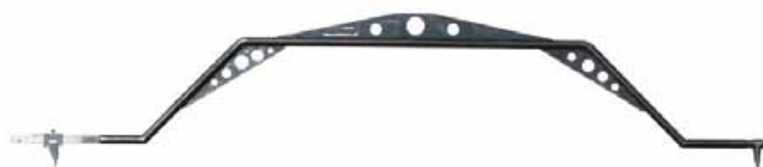
5. Przyrząd pomiarowy do pomiaru przekątnych A1 i A2
