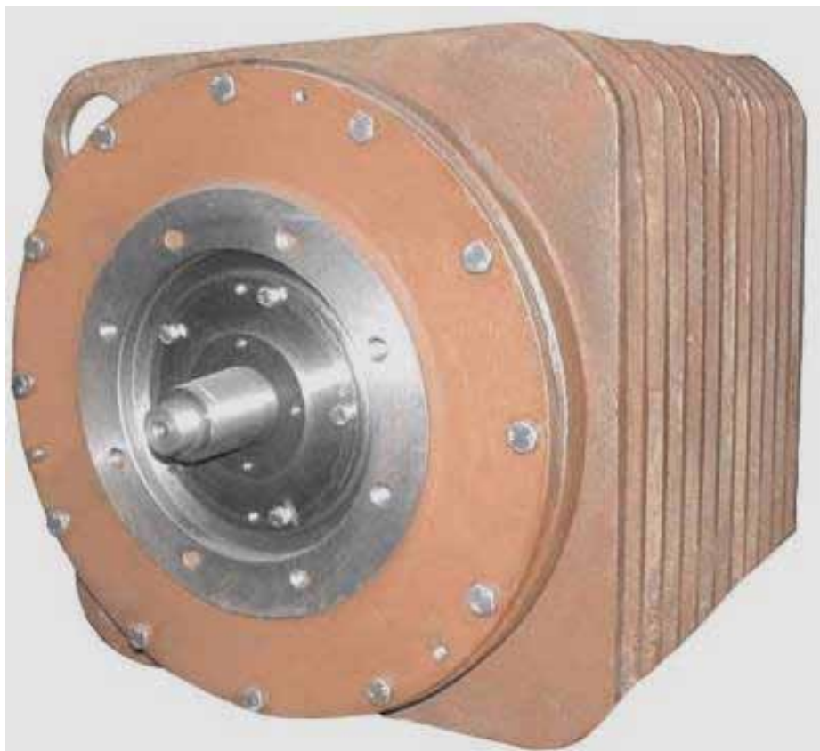
4. Silnik wzbudzany magnesami trwałymi z komutacją elektroniczną do napędu lokomotywy kopalnianej o mocy 60kW (BOBRME Komel)
