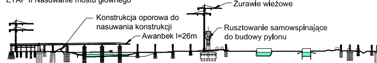
ETAP III Nasuwanie mostu głównego
