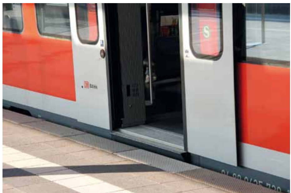
10. S-Bahn RheinNeckar umożliwia wsiadanie bez barier na prawie wszystkich stacjach w Nadrenii-Palatynacie, na których się zatrzymuje. Dodatkowo z pociągu wysuwa się specjalna rampa zmniejszająca dystans do peronu. Na zdjęciu dworzec Mitte w Ludwigshafen.
